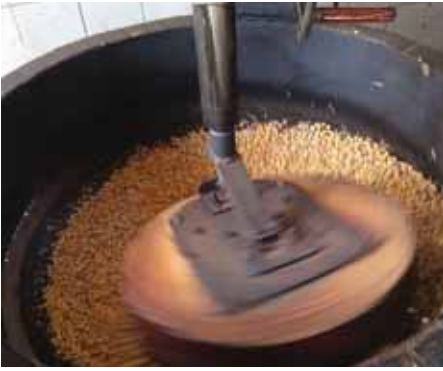
7: Tuğladan yapılmış tava denilen, nohudun kabuğunu soyan makine
